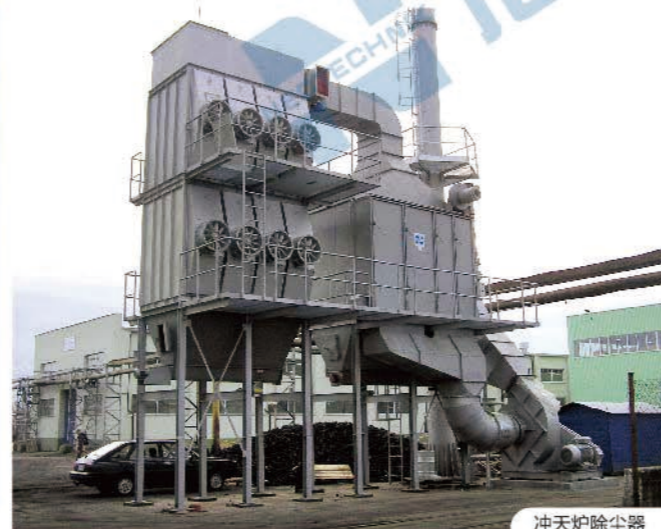
冲天炉除尘器
