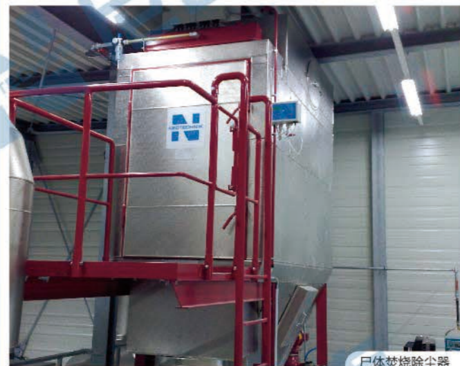
尸体焚烧除尘器
